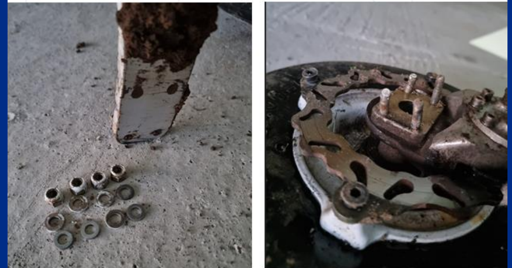
Fig. 5 – Tren aterizare principal – sistem prindere ax roată din stânga
