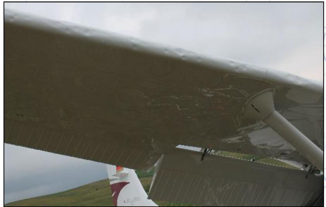
Fig. 27 - Urme lovituri de grindină bordul de atac aripă dreapta
