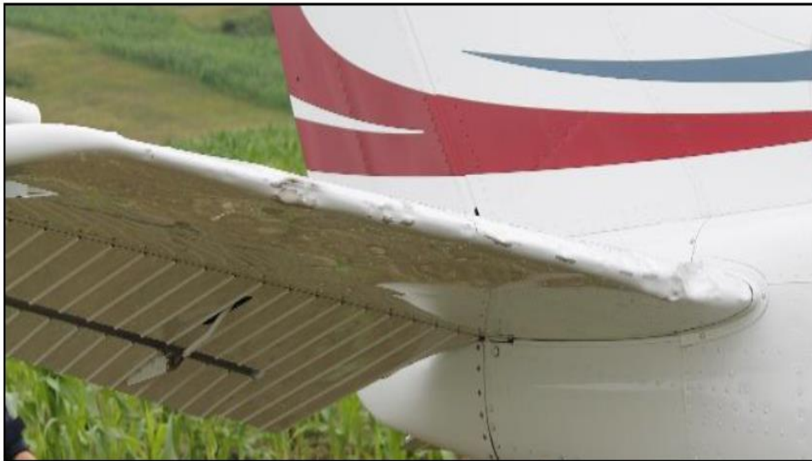
Fig. 28 – Urme lovituri de grindină stabilizatorul orizontal
