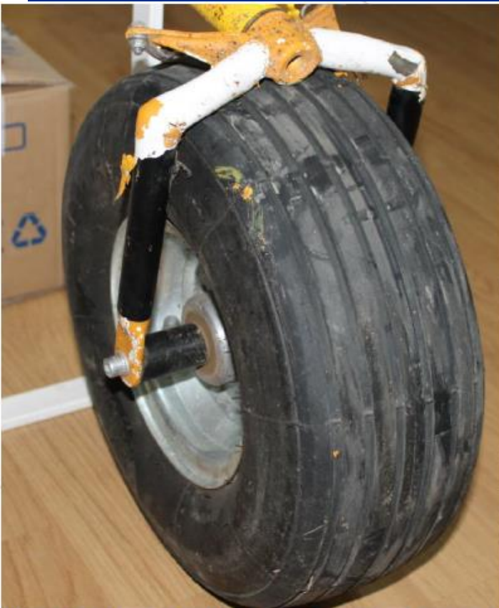
Fig. 8 Urme ale transferului de vopsea de pe furca pe roata
