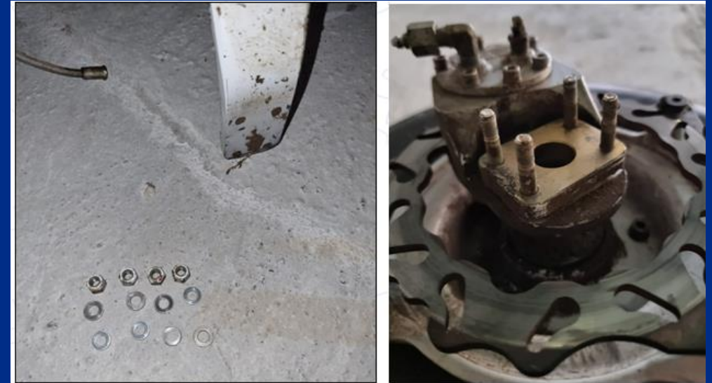
Fig. 4 – Tren aterizare principal – sistem prindere ax roată din dreapta
