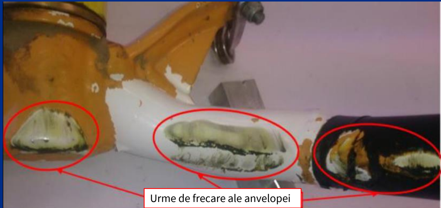
Fig.11 Urme ale frecării roții de bot cu furca
